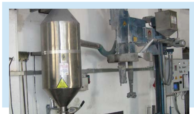
Odplyňovací zařízení Foseco v tavárně
